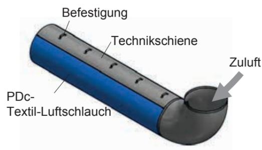
Die Lufteinbringung über Textilschläuche ist in der Molkereibranche ein gut etabliertes System. Der Vorteil liegt in der zugfreien Lufteinbringung und der gleichmäßigen Luftverteilung.
